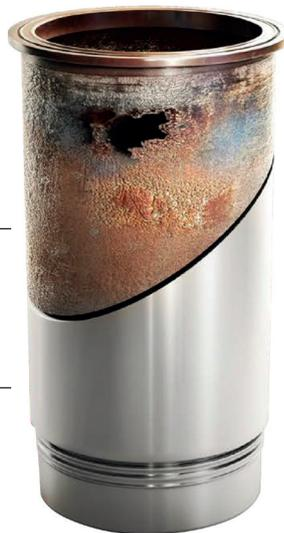
Zylinderlaufbuchse aus demselben Motorlauf **mit Perkins ELC**
